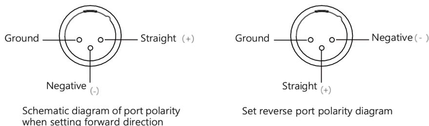
Wenn das angeschlossene Audioequipment eine vertauschte Polarität aufweist, können Sie unter „Audio Setting > XLR port polarity“ die Einstellung anpassen.
