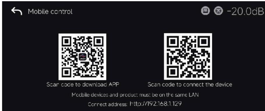
Der X9 ist über mobile Geräte steuerbar. Scannen Sie dazu den linken QR Code im Gerätemenü, um die App für Android oder iOS herunterzuladen. Der rechte QR-Code ermöglicht eine direkte Steuerung im Browser.
