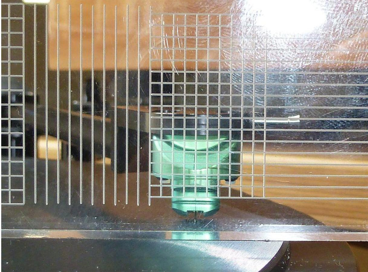
Die letzten Handgriffe betreffen noch die Einstellung der benötigten Auflagekraft, hier sind es 2.0 Gramm, und die korrekte Korrektur der Skating-Kraft. Hierzu verwenden wir wiederum eine spezielle Schallplatte mit im Pegel ansteigenden Testsignalen und stellen an der Antiskating-Schraube solange, bis beide Kanäle absolut gleichmäßig klingen.
