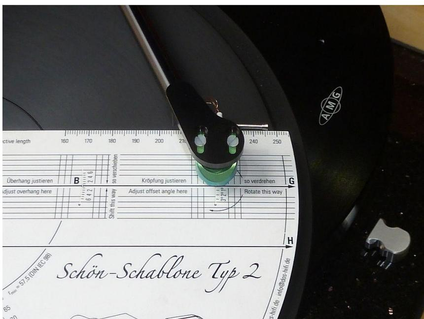
Nach dem Vertical Tracking Angle (VTA) muss auch noch der Azimut stimmen. Hier ist erst in zweiter Linie der Systemkörper die Richtlinie, sondern primär die gerade Stellung des Diamanten selbst. Zur Endkontrolle verwenden wir unser [Fozgometer](#) von Musical Surroundings und eine spezielle Test-LP mit entsprechenden Testtönen. In unserem Falle gab es aber auch gar nichts zu korrigieren oder zu kompensieren, wie das Bild eindeutig beweist.
