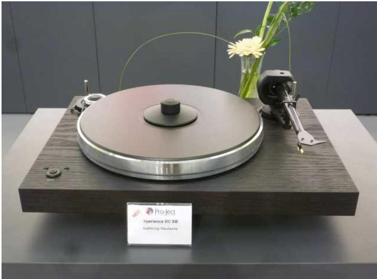
Auch an Board ist die Funktionalität der Speed Box S, die man bisher separat kaufen, anschließen und aufstellen musste. Nun sind vorne links ein Taster zum Ein- und Ausschalten sowie zwei LEDs für die Geschwindigkeitsumschaltung angebracht.
